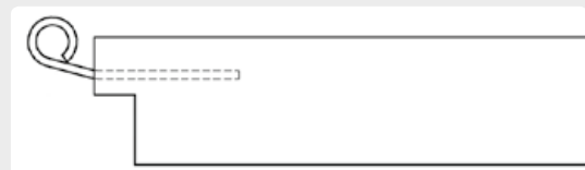
TGL Tür mit Fitschenband – Querschnitt
