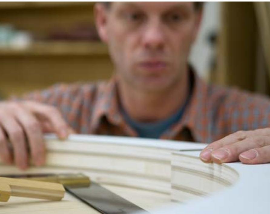
Rund- und Stichbogenelemente werden von Hand nach Maßvorgaben des Kunden gefertigt.
