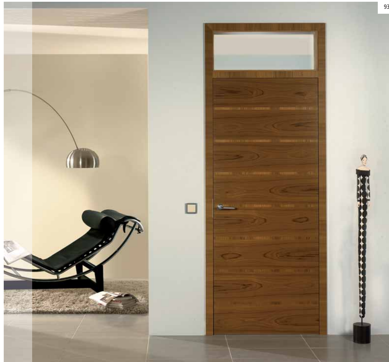
HGM Wohnraumtür 40 Röhrenspan, Modell Furnier Art, Typ 111, Furnier: Teak, Zarge: quer furniert mit Oberlicht, Höhe 250 cm
